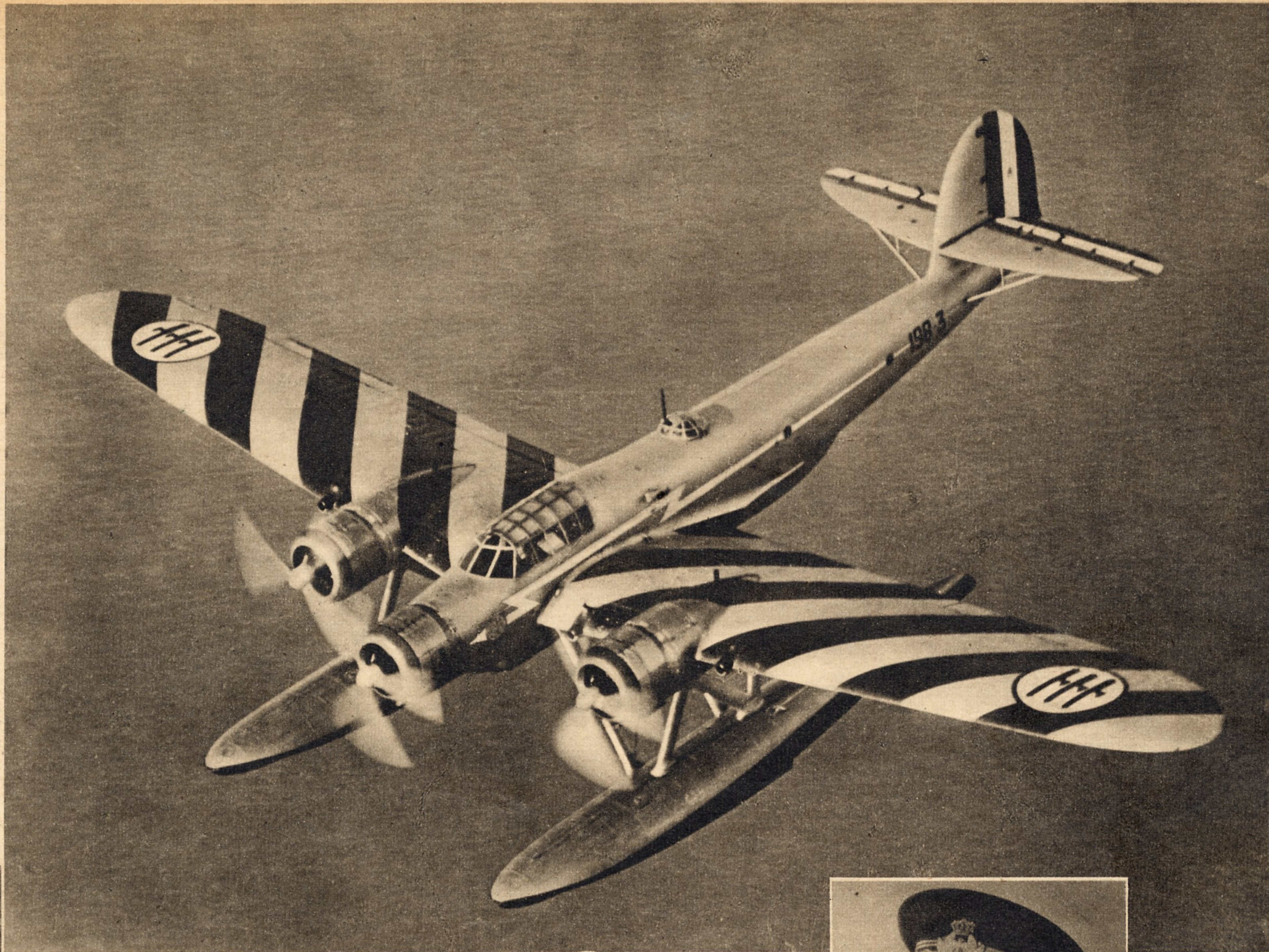
Das italienische Fernaufklärungsflugboot Cant — 506 B. Es läßt sich gleicherweise für Bomben- und Torpedowurf verwenden
